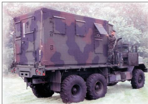
Аппаратная узла DTC (AN/TSQ-227), установленная на 5-тонном автомобиле M939
