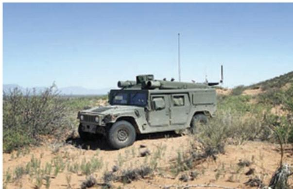
Рис. 4. Общий вид самоходного ПТРК LOSAT
